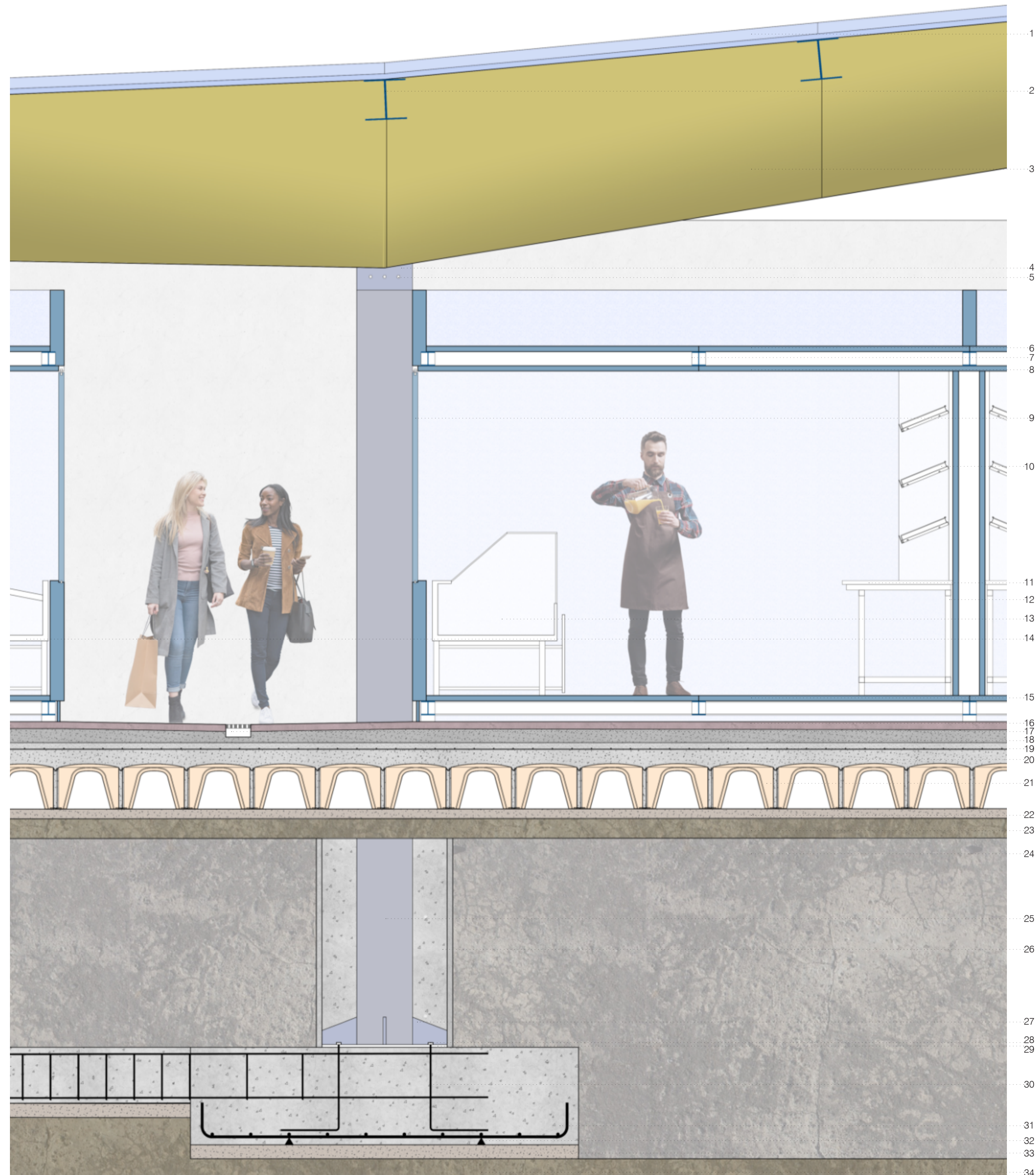
Dettaglio costruttivo scala 1:20
