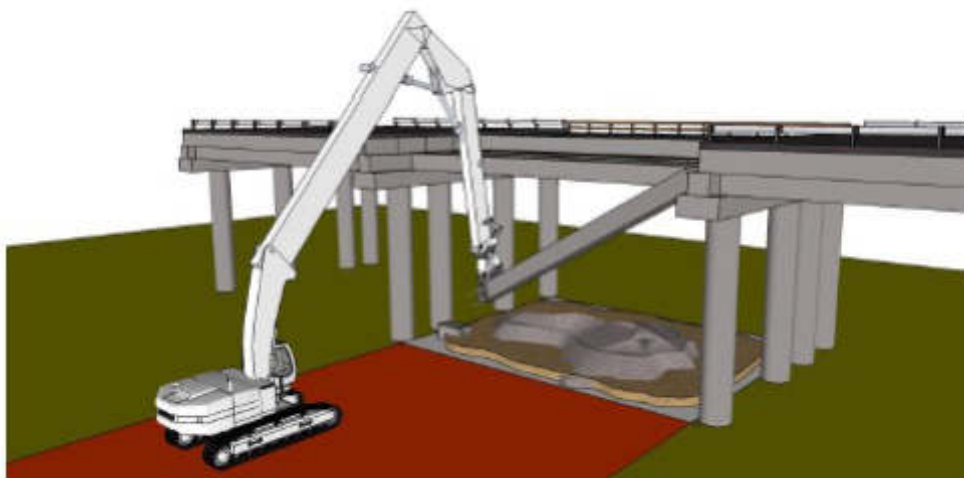
Demolizione della trave con pinza frantumatrice
