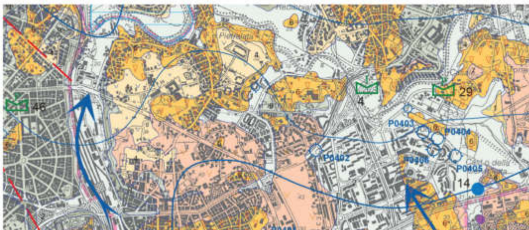
Fig. 1 - Stralcio della Carta Idrogeologica (ingrandimento 1,5x. Sorgente, linee isopiezometriche, direzioni di deflusso e pozzi sono rappresentati con lo stesso colore (blu) della falda alla quale sono relazionati.
