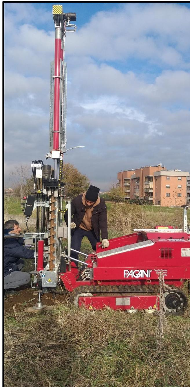
*Figura 6.15– Foto di campo delle Indagini Penetrometriche DPSH\_2*
