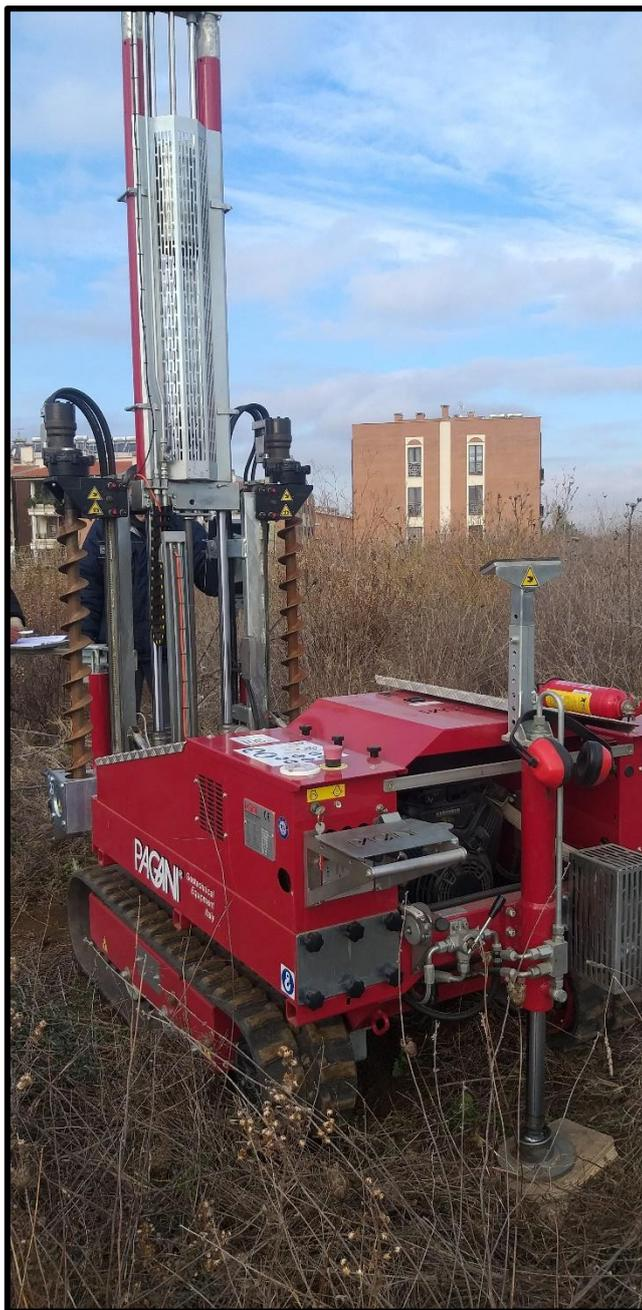
*Figura 6.19– Foto di campo delle Indagini Penetrometriche DPSH\_1*
