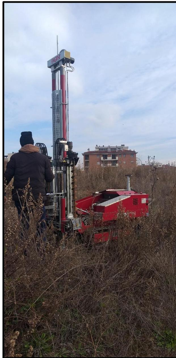
*Figura 6.17– Foto di campo delle Indagini Penetrometriche DPSH\_3*
