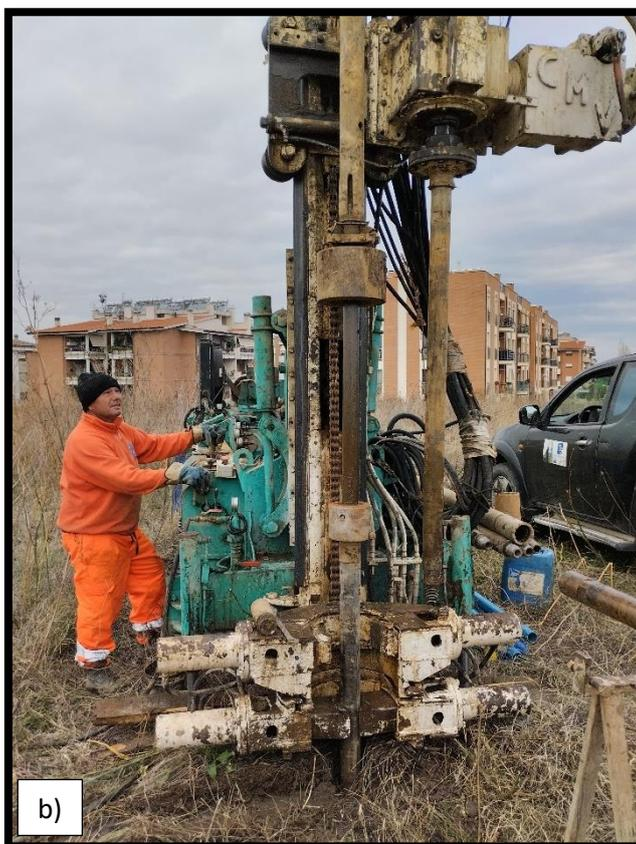
*Figura 6.8 – Esecuzione sondaggio a carotaggio continuo S3; a) Esecuzione del Sondaggio Geognostico; b) Esecuzione delle prove SPT.*
