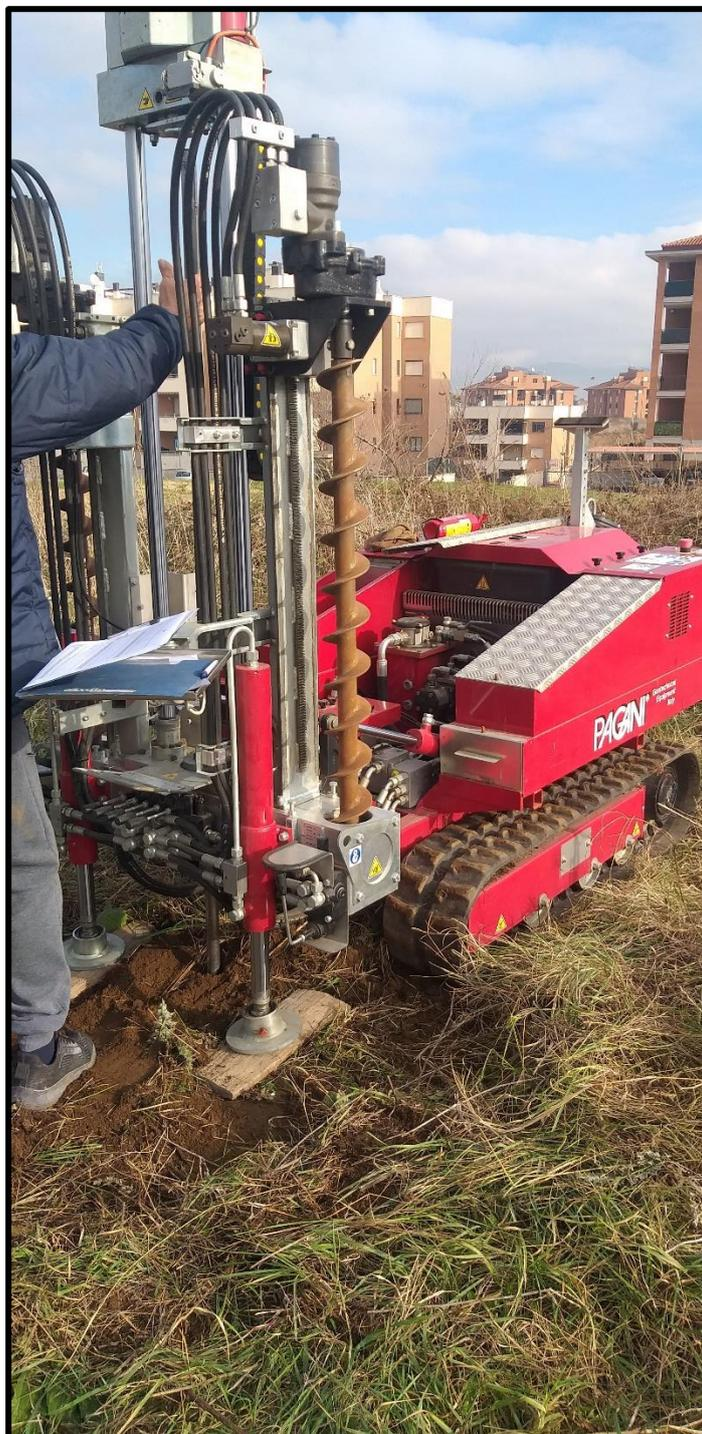
*Figura 6.13– Foto di campo delle Indagini Penetrometriche DPSH\_1*
