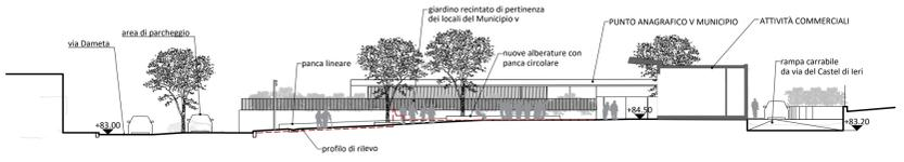
Sezione di progetto A-A' - scala 1:300
