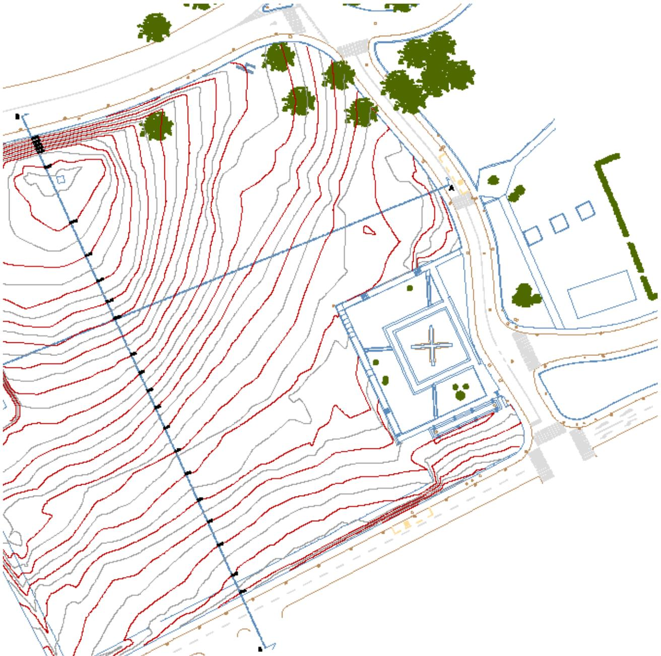
Figura 6 – stralcio rilievo plano-altimetrico eseguito con stazione totale.
