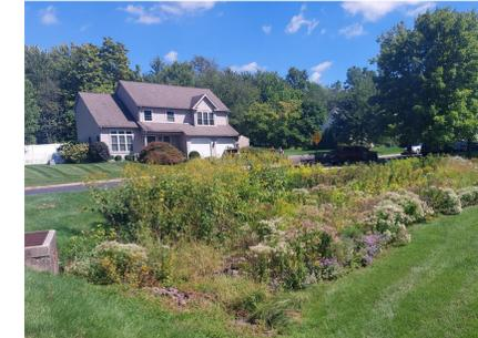
Foto 6: Giardini della pioggia, dispositivi vegetali finalizzati principalmente a limitare la portata delle acque di deflusso superficiale e ridurre sensibilmente la possibilità di allagamento in caso di fenomeni piovosi estremi e non solo.
