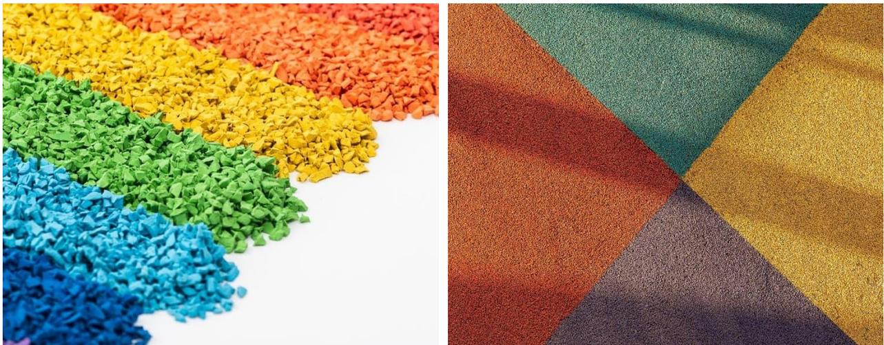
Figura 12- Immagine di riferimento dello strato di finitura della gomam colata. La finitura in EPDM è applicata al di sopra di uno strato di base in SBR a spessore variabile in funzione dell'altezza di caduta.
