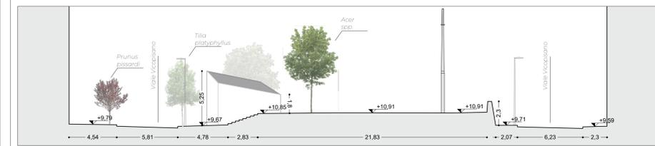
Stato di progetto - Sezione B-B' - scala 1:200
