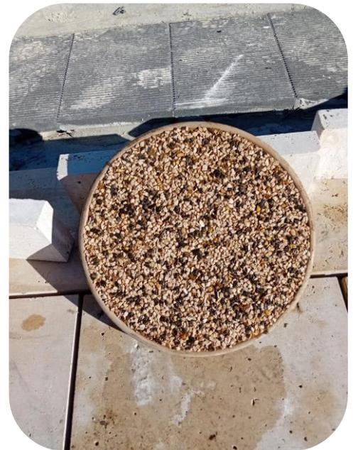
Sequenza fotografica delle ultime fasi di cantiere sul Via di S. Gregorio lato Celio, con individuazione della scelta della miscela, in pasta colorata e inerte calcareo con aggiunta di inerte di basalto, per il passaggio ciclabile condiviso con il Parco Archeologico del Colosseo della Soprintendenza di Stato e posata sul Lotto 2 del GRAB in adiacenza al Parco delle Tombe della Via Latina.
