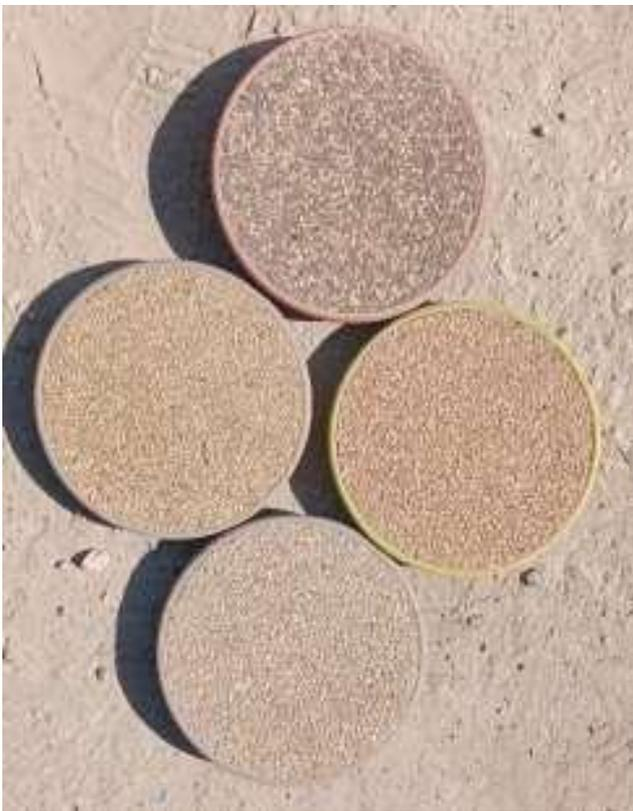
**CAMPIONI REALIZZATI DAL CEMENTIFICIO FIORENTINI.** Miscele di cemento con ossidi di varia colorazione, neutra, gialla tabacco e marrone 1%, con inerti calcarei e di basalto. I quattro provini sono stati realizzati per il sopralluogo di fine agosto 2024 concordato con le Soprintendenze. Dalle schede tecniche la composizione degli aggregati risulta la seguente:
