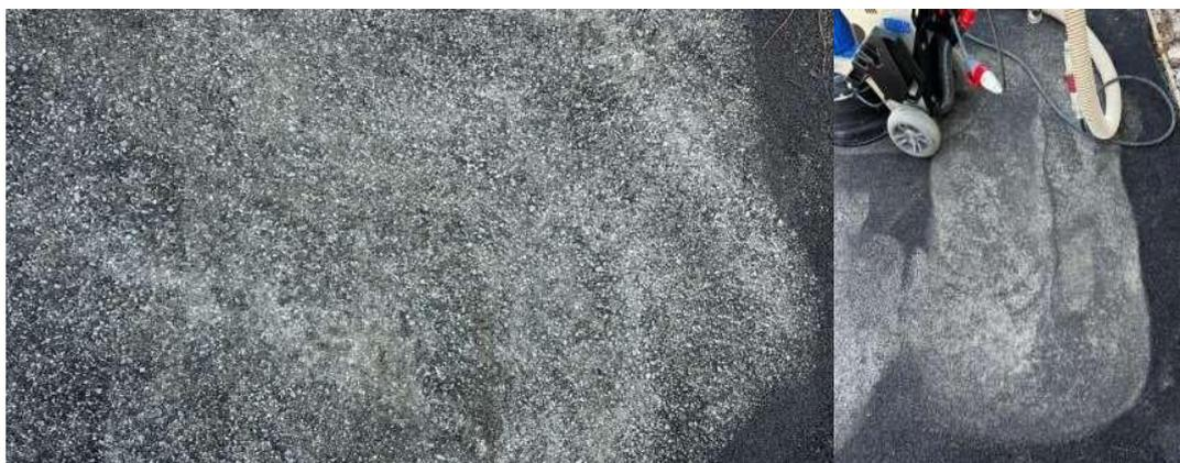
Prova fallimentare con molatura- miscela bituminosa e basalto su banco di prova 21 agosto 2024
