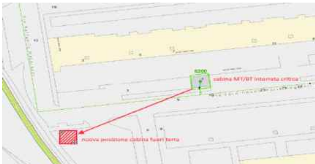
FIGURA 3 - ESEMPIO DELOCALIZZAZIONE CABINA INTERRATA
