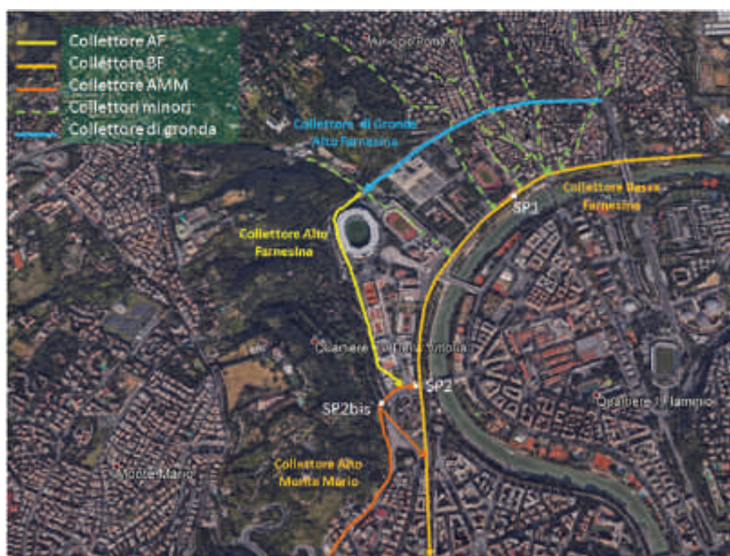
Schema collettore Alto Farnesina (giallo)
