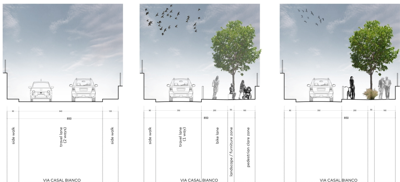
Fig. Sezione di studio di via Casal Bianco; a sinistra è riportata la configurazione attuale a doppio senso di marcia, mentre a destra l'ipotesi di carreggiata unica con sezione allargata del marciapiede pedonale.
