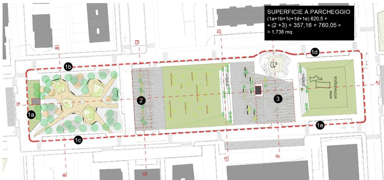
Fig. Calcolo delle superfici destinate a parcheggio nella nuova configurazione di progetto
