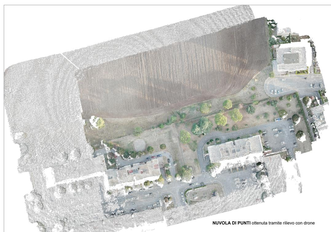
NUVOLA DI PUNTI ottenuta tramite rilievo con drone
