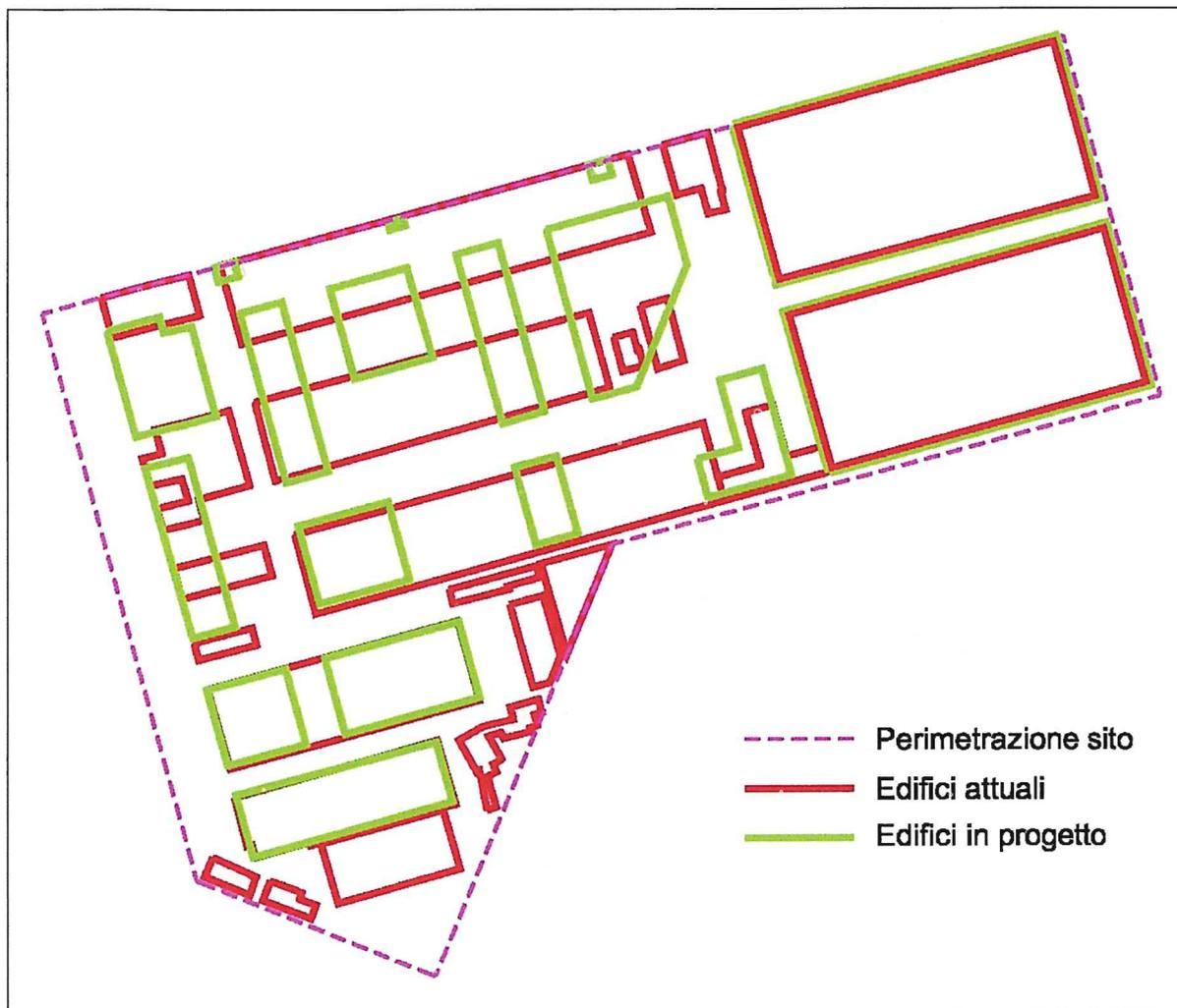
**Figura 9 – Confronto fra gli edifici esistenti (da demolire) e gli edifici in progetto**
