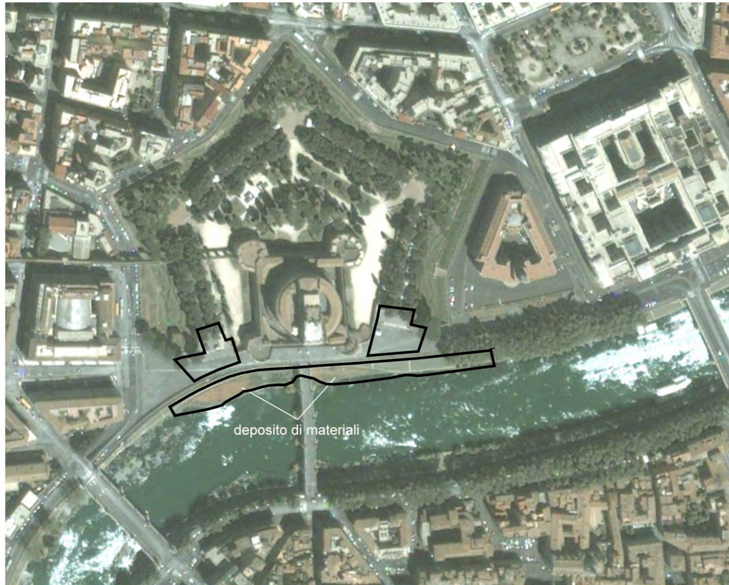
La banchina sotto Castel Sant'Angelo appare ridotta in corrispondenza di Ponte Sant'Angelo e si nota il deposito di materiale da entrambi i lati di esso.
