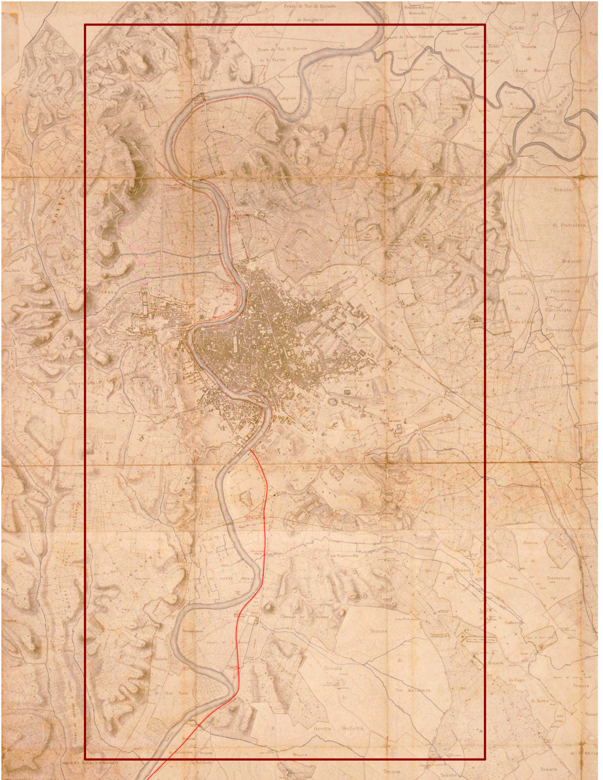
Carta topografica del suburbio di Roma_Pianta d'insieme del Progetto della sistemazione idraulica ed edilizia del Tevere In rosso si evidenzia il tracciato del collettore per deviare le acque del Tevere
