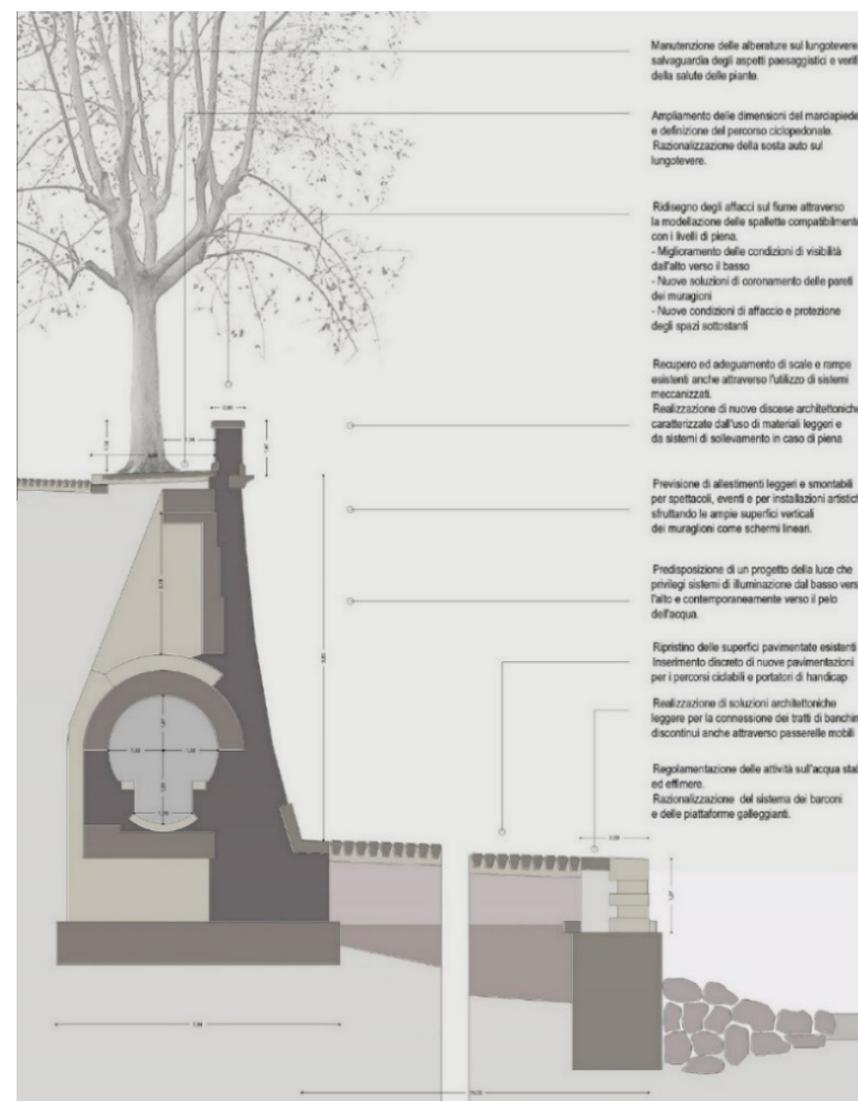
Sezione del muro di sponda e del collettore dalla Relazione del Canevari
