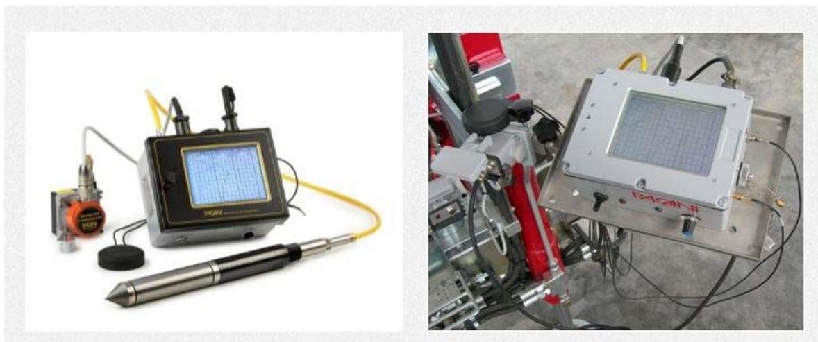
Il sistema di acquisizione TGAS03 è composto da un elemento di acquisizione, da un encoder, dalla punta digitale e dal sistema di collegamento via cavo che permettono il trasferimento dei dati dalla punta ai componenti del sistema :posti all'interno del mezzo di spinta :
