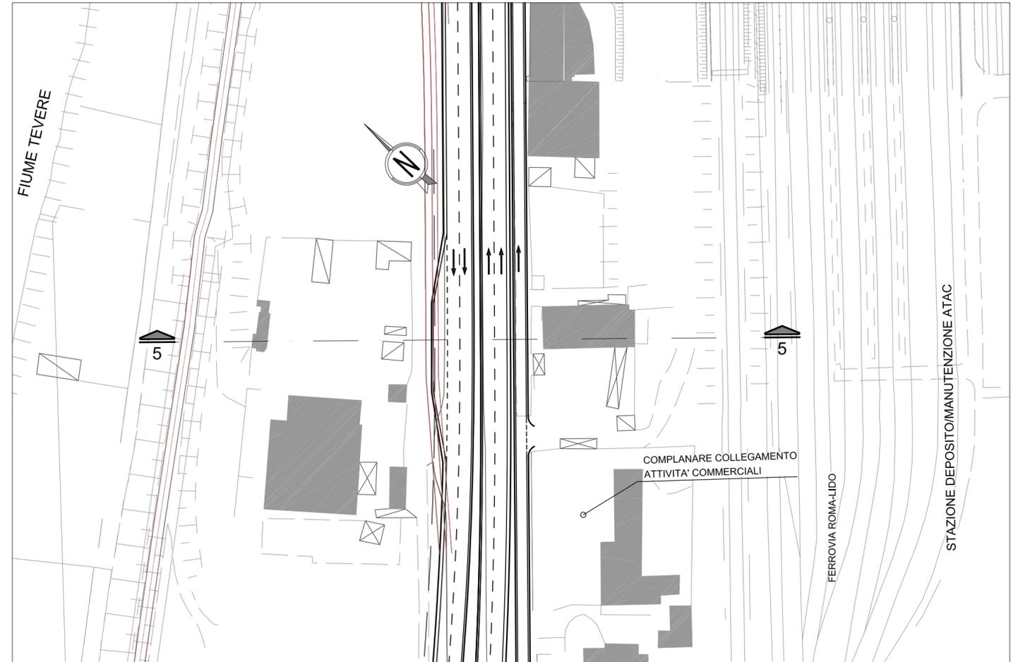
LA NUOVA CARREGGIATA UNIFICATA DIREZIONE GRA OCCUPA INTERAMENTE LA PIATTAFORMA STRADALE ATTUALE DELLA "VIA DEL MARE", LA CUI LARGHEZZA CONSENTE L'INSERIMENTO DELLE DUE CORSIE DI MARCIA E UNA BANCHINA DESTRA DI LARGHEZZA SUPERIORE AI 2m.
