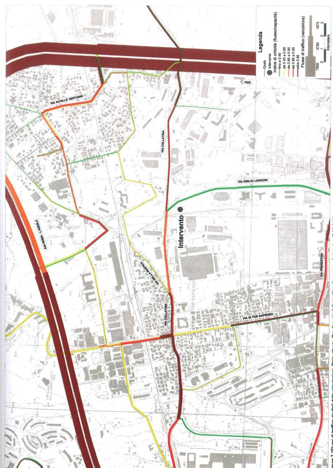
Figura 7.1Flussi di traffico risultati dalle simulazioni. Stato attuale. Ora di punta della mattina di un giorno feriale tipo (7:30-8:30)
