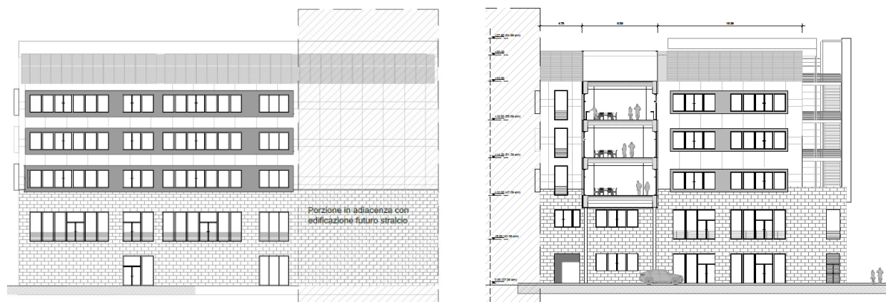
Prospetto Nord sulla corte interna e Prospetto Ovest (B) sulla strada interna, con il ponte di collegamento con l'edificio adiacente
