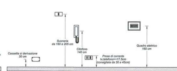
QUOTE DI INSTALLAZIONE DELLE APPARECCHIATURE PER INVALIDI
